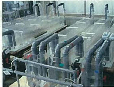
水路を想定した浄化試験装置
